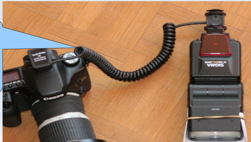
Exemple de photo faite avec la rallonge TTL. En étant déporté le flash n'éclaire plus le fond : le sujet s'en détache mieux.
